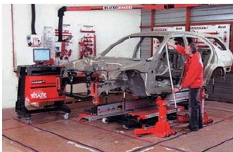
Рисунок 14 - электронная система измерения геометрии кузова SHARK
