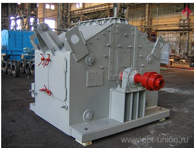
Рис. 12 Молотковая дробилка с шарнирно-подвешенными молотками
