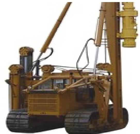
Сваебой, гусеничный копер СП49Д с дизель молотом
