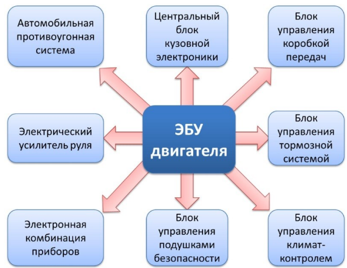
Электронные блоки управления, применяемые на автомобилях ВАЗ
