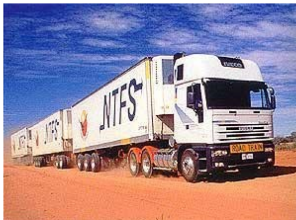
Рисунок 1.5 - Седельный тягач IVECO общей массой до 100 т
