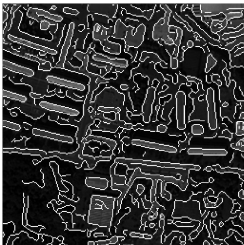
а) Результат применения детектора Кенни и преобразования Хафа
