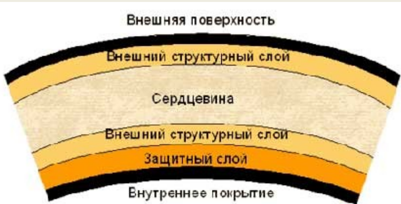
Структура стеклопластиковой трубы
