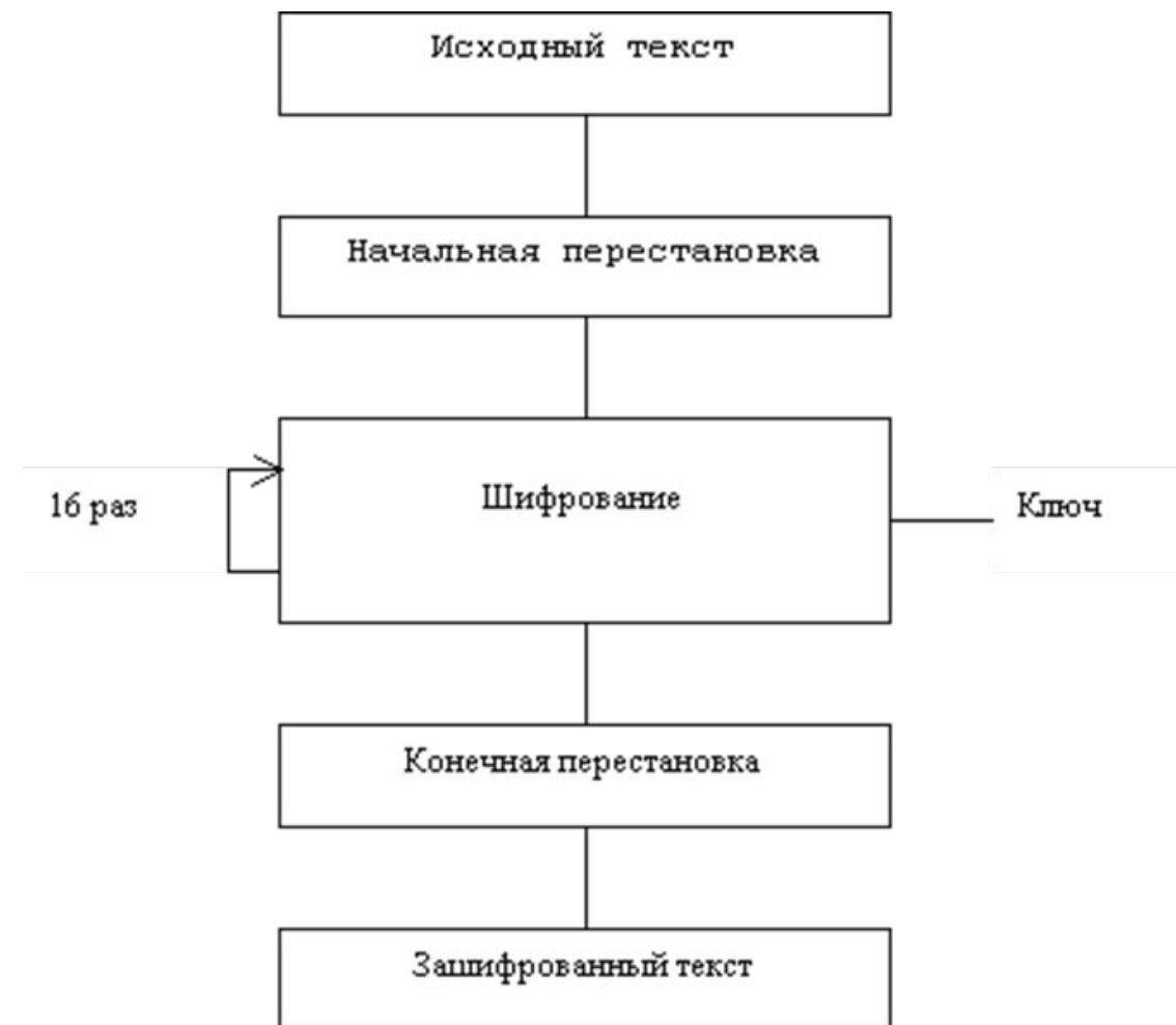
Обобщенная схема шифрования в алгоритме DES
