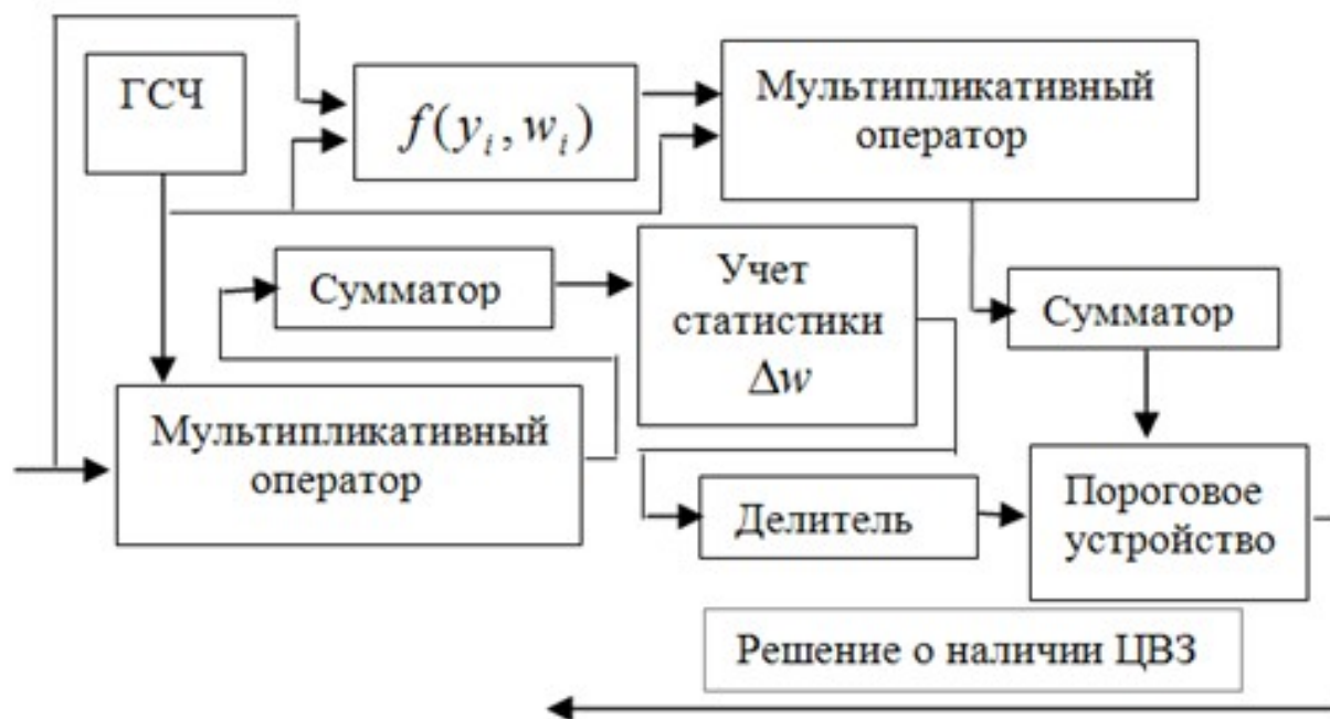
Блок-схема стегокодера и стегодекодера
