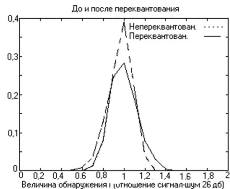
Влияние переквантования сигнала на ЦВЗ
