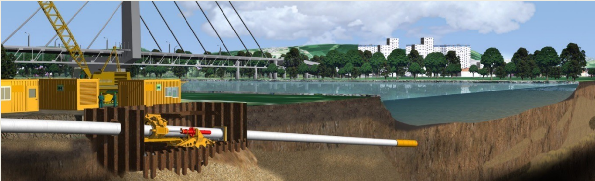
Строительство подводного перехода технологией Direct pipe
