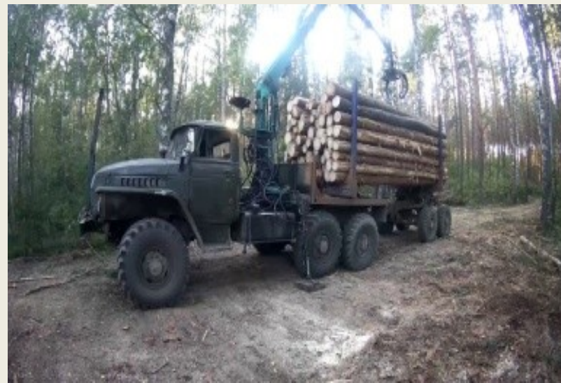
Лесовоз Урал 375 с прицепом- ропуском и манипулятором Fiskars
