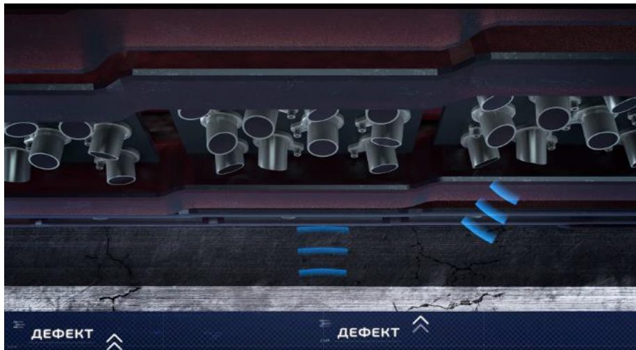
Принцип действия ультразвукового комбинированного дефектоскопа (WM+CD)
