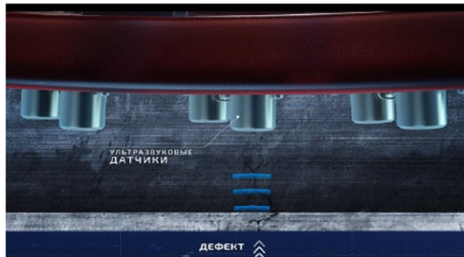
Принцип контроля ультразвуковым дефектоскопом типа WM
