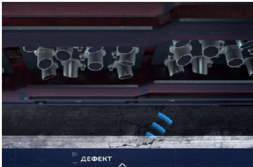
Принцип контроля ультразвуковым дефектоскопом типа CD
